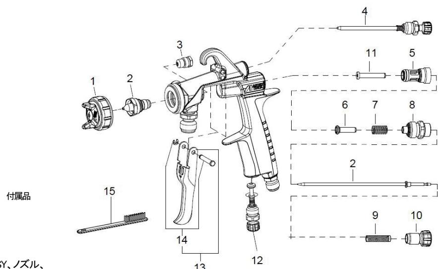
◎ 部品御注文の際は、スプレーガン形式、空気キャップ ASSY、ノズル、ニードル弁 ASSY の刻印、及び上記No. 品名を御指定ください。
